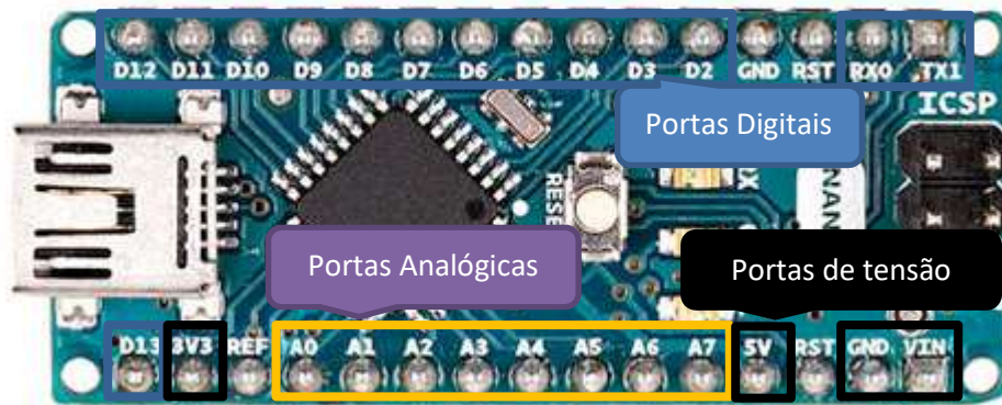
Figura 4 - Arduino nano, portas digitais, analógicas e de tensão
