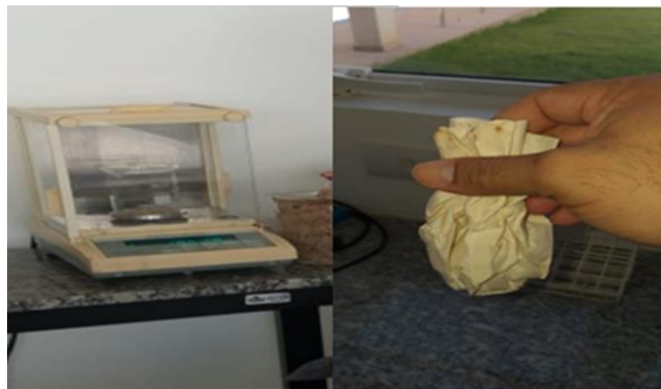
Figura 7 - Pesagem da amostra de sementes de Commiphora leptophloeo trituradas; preparação de cartucho com papel filtro para extração do óleo
