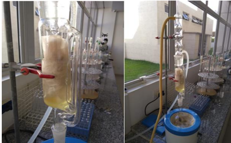
Figura 8 - Sistema de extração Soxhlet (manta aquecedora, balão volumétrico de 500ml, extrator, condensador, mangueiras, garras e suporte), extração do óleo de Commiphora leptophloeo . LBBQB da FAESF
