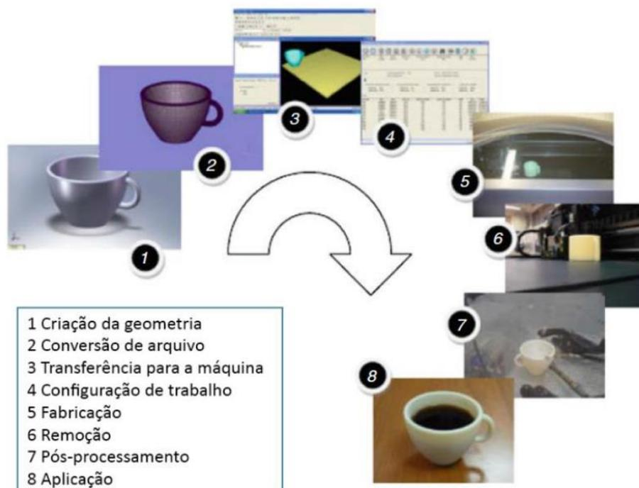
Figura 6 – etapas da elaboração do produto pelo processo aditivo da impressora 3D (MONTEIRO, 2015, baseado em GIBSON, ROSEN e STUCKER, 2010).
